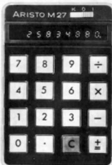
Viel ist für die Bequemlichkeit eingebaut. Bei Eingabeüberlauf kann noch weitergerechnet werden und bei Ergebnisüberlauf ist das Ergebnis noch ablesbar. Wenn die Batterien zu schwach werden, leuchten Punkte auf, die zum Batteriewechsel auffordern.
